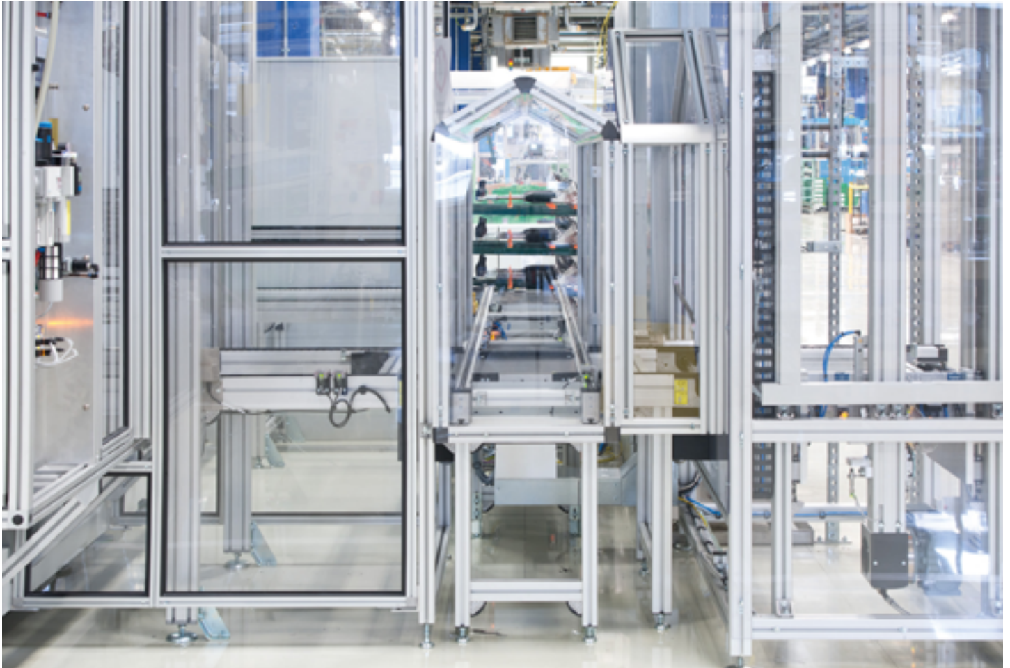
Gestelle und Umhausungen aus dem Aluminium-Profilbaukasten von Bosch Rexroth
