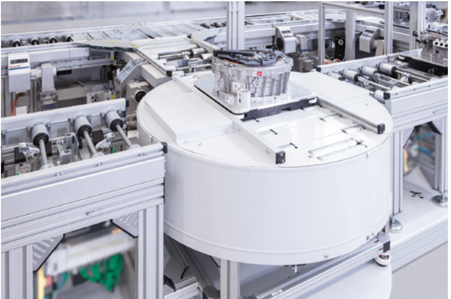
Fertigungslinie mit einem Transfersystem aus dem Hause Bosch Rexroth
